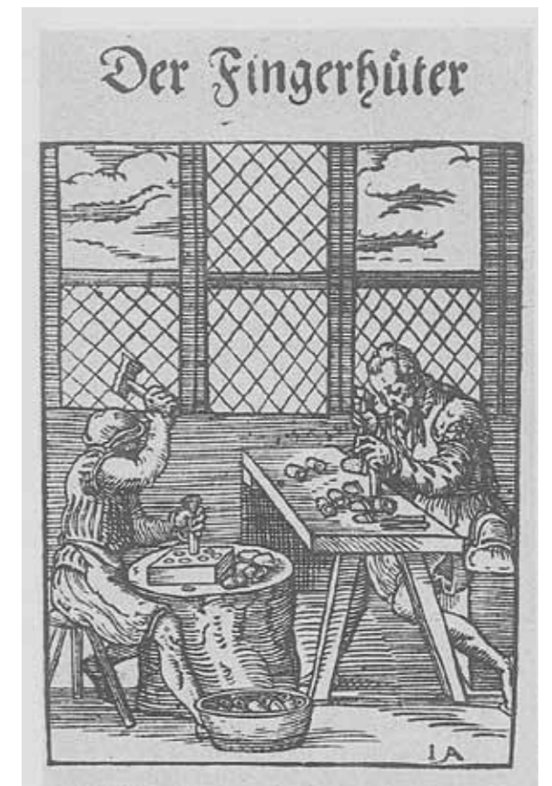
Bild 13: Der Fingerhüter bei der Arbeit mit der Dreule (Drillbohrer) zur Herstellung der Vertiefungen. Um 1400, Nürnberg.
